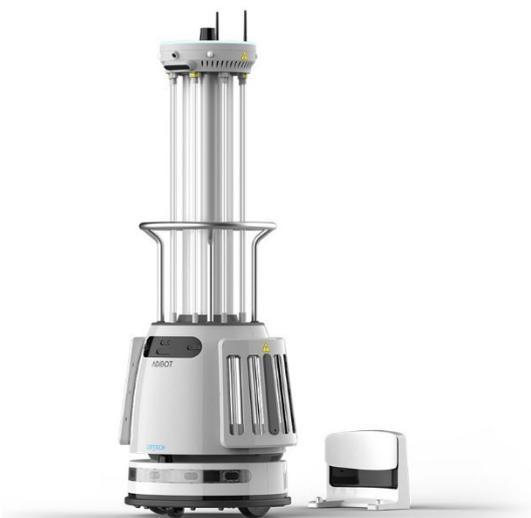
UV-Desinfektionsroboter Adibot A mit Ladestation
