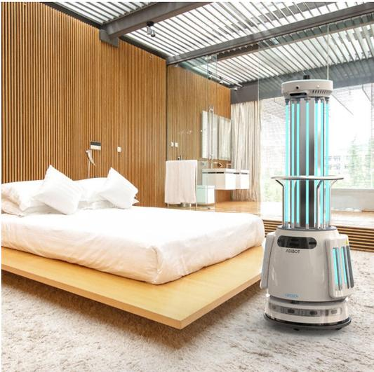
UV-Desinfektionsroboter Adibot A – Einsatz im Hotel
