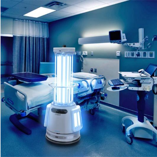
UV-Desinfektionsroboter Adibot A – Einsatz im OP-Saal
